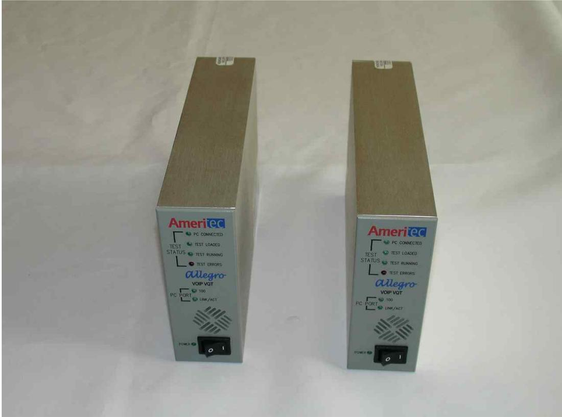
VoIP 호 발생 및 시험 측정
